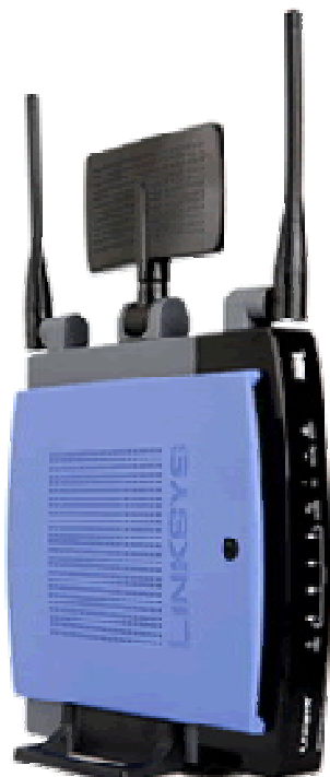
Přístupové body (access pointy či AP) - z 99% samostatné jednotky s vlastním napájením
