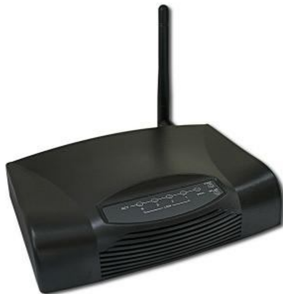
Přístupové body (access pointy či AP) - z 99% samostatné jednotky s vlastním napájením
