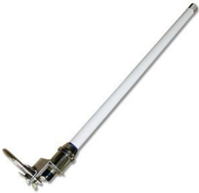
WaveRF OMNI8 - všesměrová, zisk 8dBi
